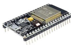
Fig. 5. Wi-Fi Module (ESP32)
